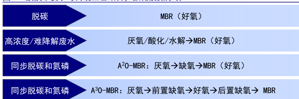
图 1：膜技术便于与传统工艺结合，强化脱氮除磷
