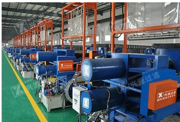
图表 12：公司压滤机在市政污泥脱水领域的应用
